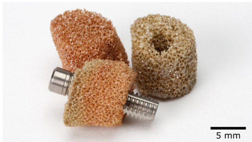
Tab af knoglevæv i kæben efter infektioner er et stort brugsområde. Hvis man skal kunne indsætte kunstige tænder, skal stifterne have noget at fæstne sig i. Nutidens brug af koknogle giver svag genvækst af knogle. Det, som vokser i den porøse titanoxid, bliver meget stærkere. (Foto: Corticalis AS)
